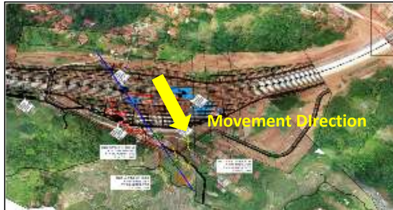
Gambar 7. Arah Pergerakan Tanah Berdasarkan Pengamatan Inklinometer Dengan Grafik Kesalahan pada Hasil Pengamatan Inklinometer mengindikasikan pergerakan tanah yang terjadi pada kedalaman 31 m dari permukaan tanah.
