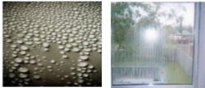
Gambar 1. Proses terjadinya dropwise dan filmwise kondensasi (JW Rose,2009)
